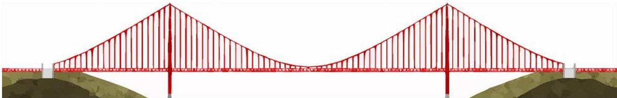
Im Querschnitt beschreibt das durchhängende Seil in der Mitte der Brücke näherungsweise eine Parabel. Die zugehörige quadratische Funktion  $f$  kann durch die Funktionsgleichung  $f(x) = \frac{280}{819200}x^2 + 20$  mit  $\mathbb{D}_f = [-640; 640]$  beschrieben werden, wobei  $x$  und  $y$  in Metern angegeben werden. Dabei wird die  $x$ -Achse des Koordinatensystems auf Höhe der Straße gelegt.
